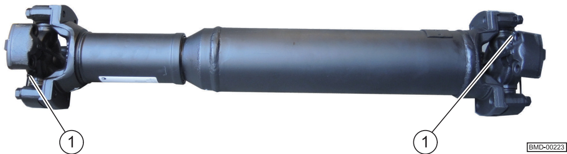
Fig. 9.5: Puntos de lubricación del árbol cardán
