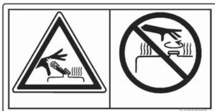
La indicación advierte del peligro de quemaduras por saltar agua o aceite caliente si el radiador o el tanque hidráulico se destapan cuando aún están calientes.
