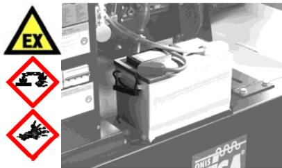
Batería de alimentación: peligro de corrosión, explosión.
