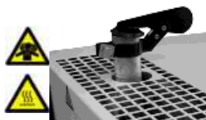
Extremo de la descarga: peligro de quemaduras, químico
