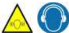
Riesgo que se deriva del ruido provocado por máquinas caracterizadas por Leq≥80 dBA.
