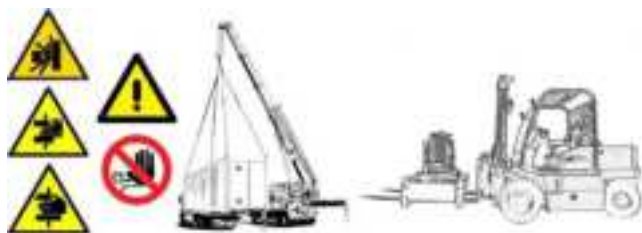
Zona de desplazamiento: peligro de aplastamiento. Prohíba la entrada en el radio de acción de las máquinas de desplazamiento.
