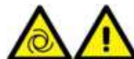
En máquinas con encendido automático, el GE podría encenderse de forma autónoma. Antes de realizar los trabajos, apague la máquina y tome las precauciones necesarias para que no se vuelva a encender.
