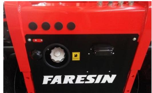
El tapón de cierre es de rosca con llave de seguridad. Para quitar el tapón hay que girarlo en el sentido contrario a las agujas del reloj, para volver a enroscarlo hay que girarlo en el sentido de las agujas del reloj. El depósito del gasóleo se caracteriza por tener una capacidad total en litros de 80 l (incluyendo 20 litros de reserva). Recomendamos no llenar completamente el depósito para permitir la expansión del combustible a temperaturas ambientales altas.
