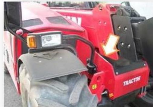
Los datos principales del motor diésel y su número de matrícula se imprimen en la placa colocada en el punto indicado en la figura.
