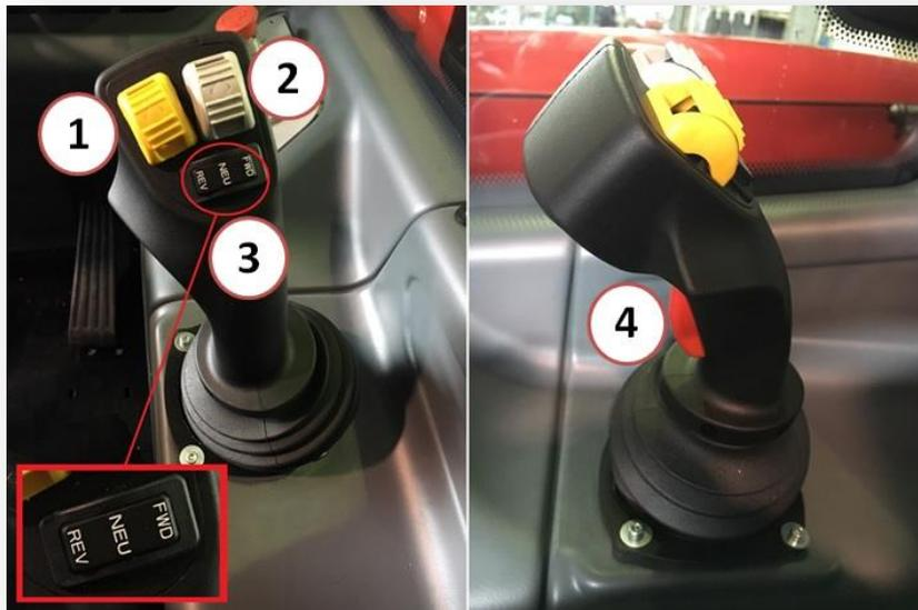
El joystick se puede mover en las cuatro direcciones: adelante, atrás, derecha e izquierda.
