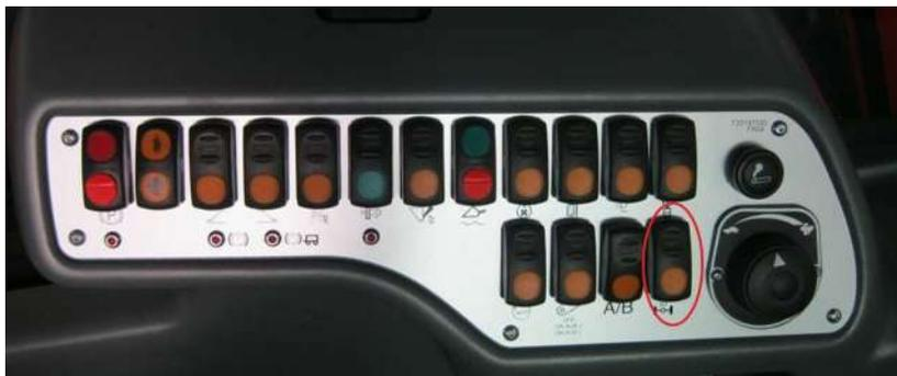
El bloqueo de la oscilación del eje se activa mediante el correspondiente botón situado en el segundo salpicadero lateral derecho;
