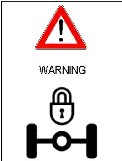
Cuando la máquina tiene los estabilizadores completamente bajados (por lo tanto la máquina está necesariamente parada) y el brazo está elevado con un ángulo superior a 30°, la lógica de seguridad de la máquina introduce automáticamente el bloqueo de la oscilación del eje.
