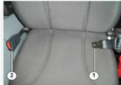
Para regular el cinturón, tire con la mano izquierda del borde del cinturón izquierdo para aumentar la adherencia al cuerpo. Si el cinturón está demasiado estrecho, desengánchelo, alargue lo necesario la parte izquierda y repita la operación de abrochado.
