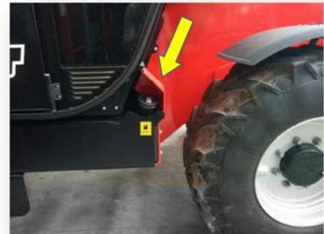
El tapón de cierre es de rosca con llave. Para quitar el tapón hay que girarlo en el sentido contrario a las agujas del reloj, para volver a enroscarlo hay que girarlo en el sentido de las agujas del reloj.
