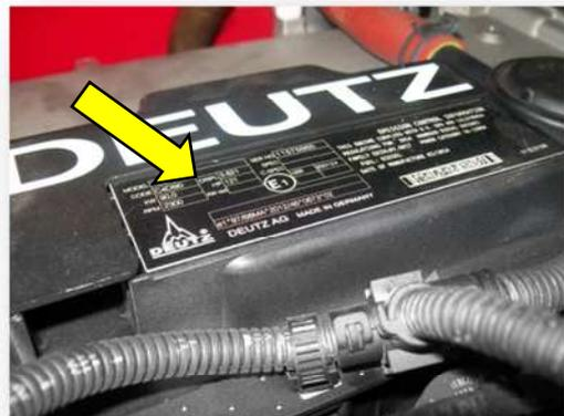
Las placas de todos los componentes principales no fabricados y/o producidos por FARESIN INDUSTRIES (por ejemplo, bombas, ejes, etc.) se aplican directamente en los componentes, en los puntos donde los respectivos fabricantes las han colocado originalmente.
