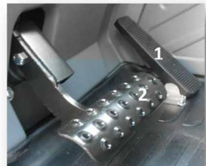
El pedal (2) se debe usar como embrague para realizar el cambio de marcha mecánica con la máquina parada (si lo hubiera). Para cambiar la marcha: poner en punto muerto, pisar a fondo el pedal del freno; pulsar el correspondiente botón presente en el panel, soltar el freno. Introduzca la dirección de movimiento, gire a la derecha ya la izquierda para favorecer el acople de la marcha; comience a moverse lentamente.
