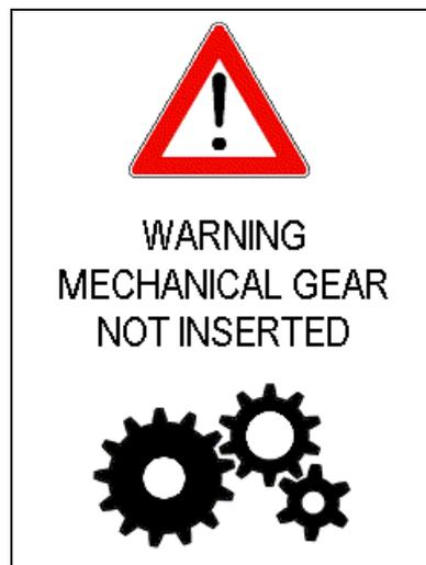
Repita la operación de introducción de la marcha con la máquina parada y el pedal del freno pisado.
