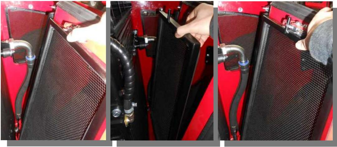
Cuando sea necesario quite las rejillas delanteras del compartimento del motor y lávelas bien. Para quitar cada rejilla, haga girar la palanca del bloqueo en el sentido de las agujas del reloj hasta que se desenganche. Cuando se haya limpiado, vuélvala a colocar correctamente en las guías (atención, las dos rejillas no son iguales) y presione la rejilla hacia el cierre hasta bloquearla. Repita la operación también para la segunda rejilla.
