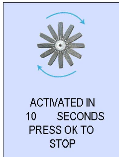
En la fase de activación es necesario que el régimen del motor sea inferior a las 1800 rpm; de lo contrario, aparecerá la pantalla siguiente.
