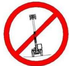
Se prohíbe usar la cuchara con brazo parcialmente o totalmente extendido durante las operaciones de carga.
