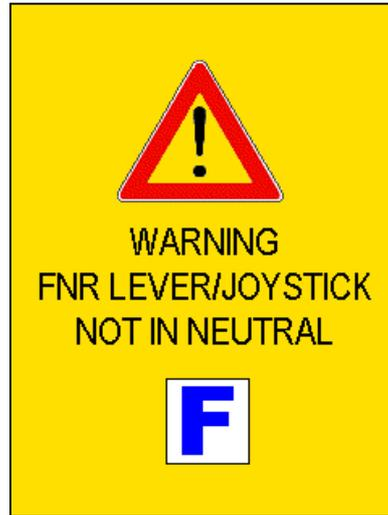
En caso de que el operador active el sistema de nivelación (véase el apartado «Nivelación de la máquina»), se visualiza el aviso siguiente:
