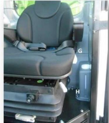
**¡Atención!** El asiento tiene un sensor que se activa cuando el operador se sienta y habilita la puesta en marcha del motor.
