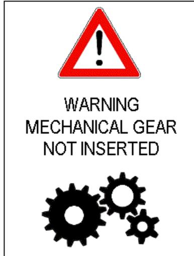
En caso de que con el eje bloqueado se supere la velocidad de 3 km/h, se muestra el siguiente aviso y se emite una señal acústica.
