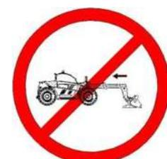
En caso de viento con intensidad mayor que 12.5 m/s (45 km/h) interrumpa las operaciones con el brazo elevado.
