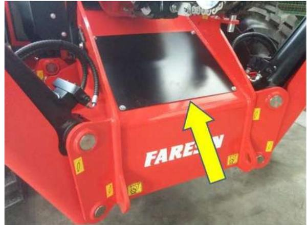
***¡Atención!*** En caso de recarga o cambio o en cualquier otra operación de eliminación de los bornes de contacto de la batería y en su seccionamiento, espere SIEMPRE un tiempo mínimo de 3 minutos desde que se haya apagado la máquina. Este intervalo es necesario para que la centralita complete su ciclo de control siguiente al apagado de la máquina.
