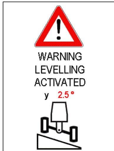
En caso de que el operador meta la marcha, con los estabilizadores no completamente elevados, y empiece a moverse, se visualiza el siguiente aviso (en caso de estabilizadores completamente bajados el avance se desactiva completamente):
