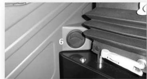
El aire que el ventilador pone en circulación se extrae en parte del exterior y en parte de la cabina (recirculación); si se trabaja durante períodos prolongados con las aberturas de la cabina cerradas, es recomendable realizar el recambio del aire.
