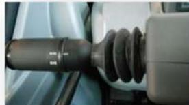
El motor no arranca si la palanca de mando de marcha o el botón del joystick (palanca de mando) no están en la posición de neutro “N” que se muestra en la pantalla.
