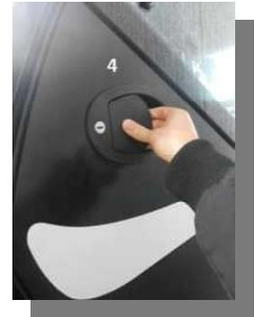
Suba y baje de la cabina de conducción siempre con la espalda dirigida hacia el exterior, asegurándose de tener tres puntos de apoyo:
