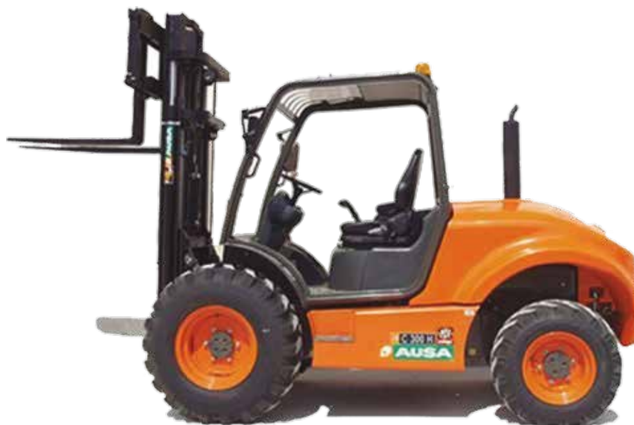
Carretilla elevadora diesel 4x4 2.000Kg
